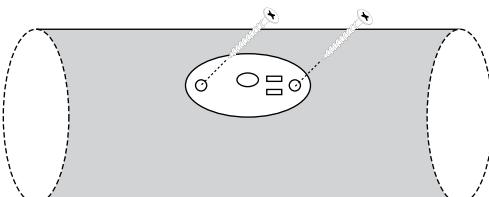
Рисунок 1б - Монтаж датчика во фланце
