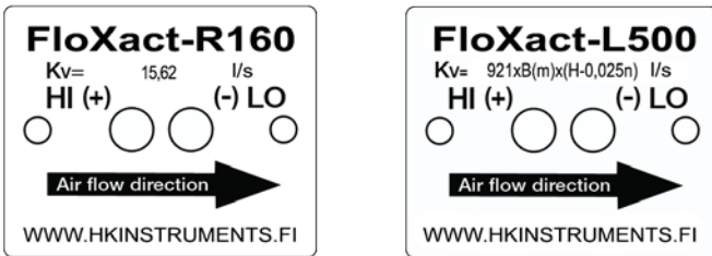
Рисунок 2 - Направление воздушного потока
